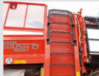
Elevator sa pet brzina omogućava optimalan transport u bunker.
