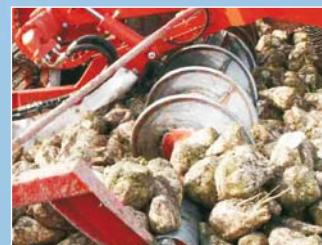
Repa se raspodijeli bez oštećenja u bunkeru veličine 28 m<sup>3</sup>.
